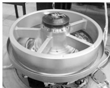
图7 实验用磁悬浮飞轮原理样机
